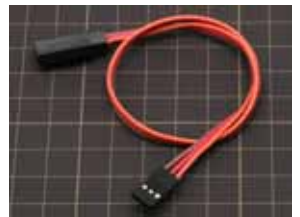
0019-21 延長サーボコード JRタイプ (250mm) 最長250mmの延長が可能。
