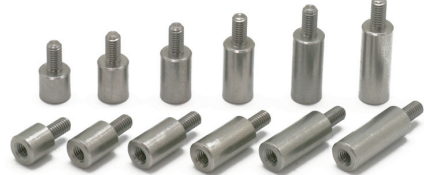
高強度ステンレスシルバー仕様 (6/8/10/12/14/16mm) スペーサー径 6mm/M3 ネジ。オネジ部は 6mm 長、 メネジ部は深さ 6mm (※6Mスペーサーのみ深さ 4mm)
