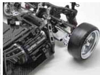
モーターの配置を左右どちらでも選べるリバーシブルモーターマウント採用
