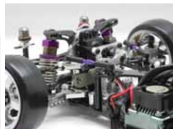
RWD専用設計によりフロントバルク中央部にステアリングサーボを配置。
