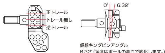
穴同士の間隔はトレール、キングピンアングル共に3.2mmです。トレール量はキャスト角の量により、変化します。ボールベアリング、アクスルシャフトは付属しません。アクスルシャフトはキット付属品(シム調整が必要)か、別売の0079-FD RWD スマートアクスルシャフトの使用をおすすめします。
