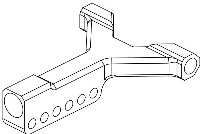
FR-D開発テストドライバー、近藤カスタム公認の革新的Type-C対応サスアーム登場。斬新なYアーム形状により、取回し自由度が大幅にアップ!ショックの取付け位置を6ヶ所設け、幅広いレバー比調整が可能。ショックを内側に寄せることで大舵角モデルのフルステア時にホイールとショックの干渉を防ぎます。高品質アルミ削出し仕様。
