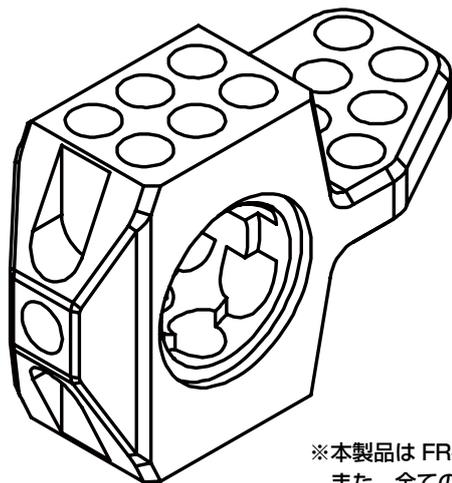
850ベアリングを採用することにより、かつて無い小型化を実現したRWD用フロントナックルです。従来のナックルに比べ、究極のスモールスクラブ実現と、ロールセンター調整の自由度が高くなりました。2種のキングピンアングル選択に加え、前後トレール変更も可能。付属のベアリングはフランジ仕様とし、アクスルシャフトの保持力を高めています。ナックル前部にはウェイト、キャリパー等の取付け用ネジ穴を接地。アルミ削り出し仕様、2個入。(左右共通)。850フランジベアリング4個入。
