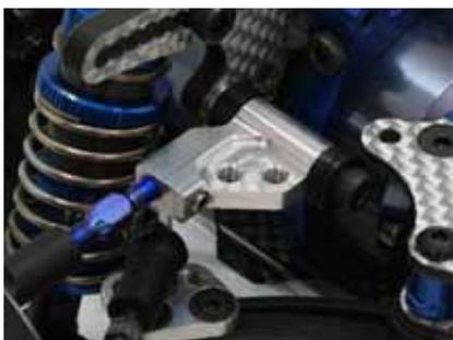
装着例。付属の1.0/2.0/3.0tのスペーサーの入替えてキャスト角の調整が行えます。
