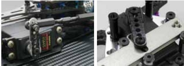
アルミ&カーボンの2ピース化により、7mm-24mmの間で無段階のレバー調整を可能とします。ダブルロック構造でホーンを確実に固定。調整の定量化が容易なゲージ付です。フタバ/SAVOX用、サンワ/KO用をラインナップ。従来のサーボホーンでは、困難だったミリレベルでの調整が可能の為、プロポ側のEPA調整の幅がひろがり、サーボ&ジャイロの性能を引き出します。
