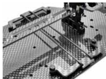
モーター下に、理想的にバッテリーを搭載するためのカーボン製のバッテリーホルダー採用。固定は付属Oリングを使用。ショートリボ用。
