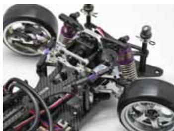
RWD専用設計のスライドステアリングユニット「VX-DOCK」が極めてガタの少ないダイレクトなステアリングフィールを生み出します。
