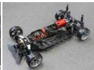
モーターマウントとギアケースを連結し、高い剛性を確保。
