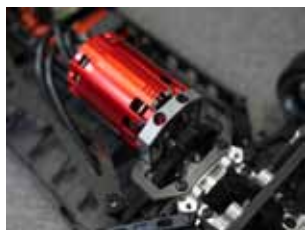
モーターマウントとギアケースを連結し、高い剛性を確保。
