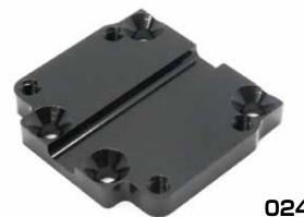
VX-DOCK を 4mm 嵩上げする「VX-DOCK 用ライジングロアプレート」が新登場。DOCK 本体を嵩上げする事で、ステアリングタイロッドの高さを適正化し、理想的なバンプ調整を可能にします。また、プレートのセンターに設けたスリットにより、サーボコードを DOCK 下部からスマートに取り回し出来ます。※本製品は0244-FD のロアプレートと共通パーツになります。
